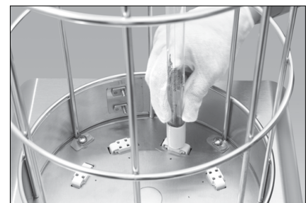
Paso 4: Inserte la Lámpara dentro de Zócalo
